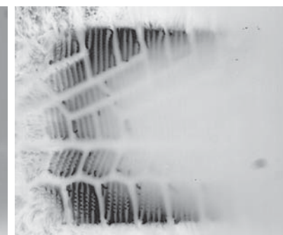
Det här är en bild fotograferad underifrån när nytt friktionsdäck plöjer genom en vattensamling som är respektive tio millimeter djup. Hastigheten är 80 km/tim. När det bara är en tunn vattenfilm på vägen håller däck bra vägkontakt. Men redan vid tio millimeters vattendjup så planar däck på vattenytan. Det lyfts upp från mitten och utåt kanterna. Det här är en mycket farlig men tyvärr inte särskilt ovanlig situation på det här slitna svenska vägnätet. Den enda lösningen är lägre fart och bättre vägunderhåll.
