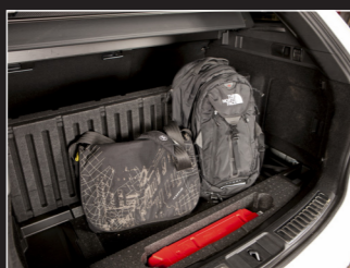
Bagageutrymmet är bäst i test. Lastvolymen är störst, både med och utan baksätet nedfällt. Baksätet fälls enkelt med ett reglage strax innanför luckan. Det går att fälla upp en lucka i golvet som håller bagaget på plats och insynsskyddet är fäst i bakluckan och följer automatiskt med upp när man öppnar.
