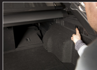
Bagageutrymmet är bäst i test. Lastvolymen är störst, både med och utan baksätet nedfällt. Baksätet fälls enkelt med ett reglage strax innanför luckan. Det går att fälla upp en lucka i golvet som håller bagaget på plats och insynsskyddet är fäst i bakluckan och följer automatiskt med upp när man öppnar.
