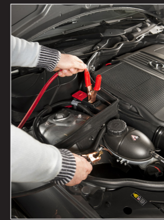
Batteriet sitter dolt i bagageutrymmet så startkablarna kopplas till särskilda nödstartspoler i motorrummet.
