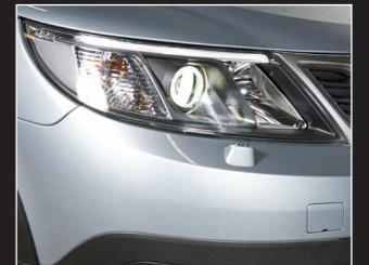
Saab har, liksom de övriga deltagarna i testet, strålkastar rengöring i form av högtrycksspoling.
